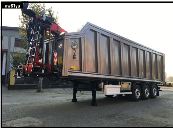
aw81ya SEMIRIMORCHIO TIPO ATLANTE C/GRU 10,5x2,55x h 2,5 mt, fondo Xar 450x5 mm, pareti 450x4, Gru Epsilon Q170L104 + polipo c/rot. NUOVI
