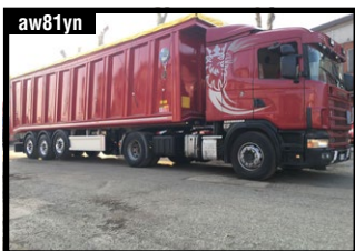
aw81yn SEMIRIMORCHIO TIPO ATLANTE tara 93 q, 11x2,55x h 2,5 mt, fondo 4 mm, pareti 3,2 mm, port. basc. e band stagna, c/s nuovi
